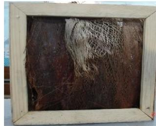
Figure I.19 : Enceinte d'humidification en bois contenant des fibres de palmier dattiers local [18].
