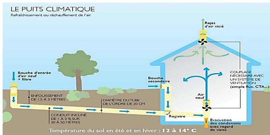
Figure I.2 : Schéma caractéristique d'une maison équipée d'un échangeur air/sol [6].
