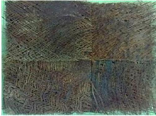
**Figure III.4 :** Tampon de refroidissement en fibre de palmier dattier [13].
