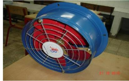
Figure I.18: Banc d'essai expérimental avec ventilateur de soufflage de l'air [18].
