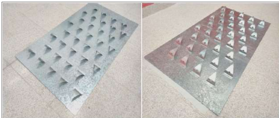
Figure II.18 : Vue picturale de la surface de l'absorbeur avec des chicanes en forme de delta courbées longitudinalement [20].
