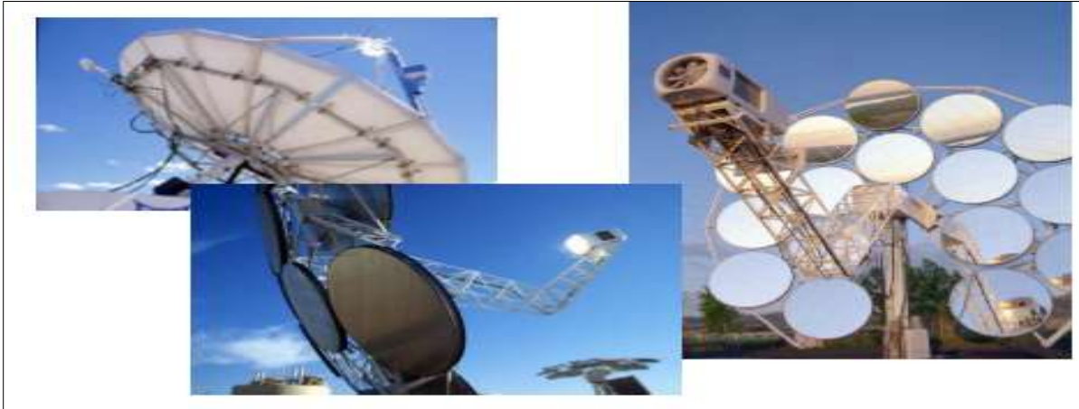
Figure I.13 : Capteurs solaire a concenreation[11].
