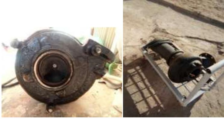
الشكل (II-4): مضخة الطرد المركزي الخاصة بمياه الصرف الصحي من داخل المحطة.
