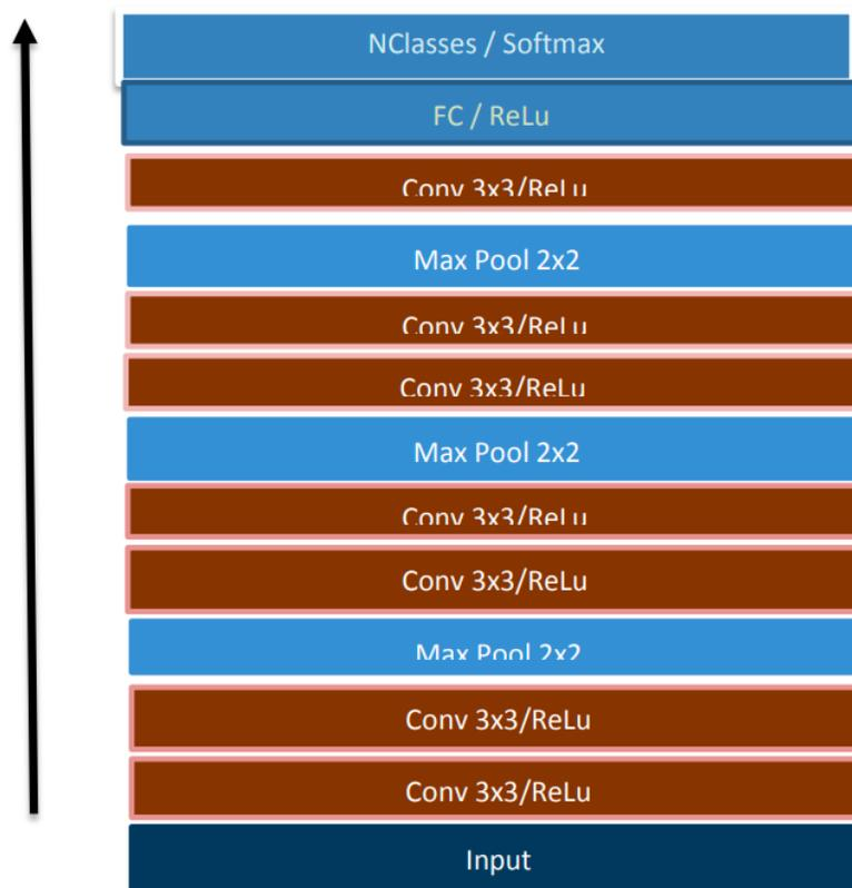
*Figure 2.1 Architecture générale d'un CNN.*
