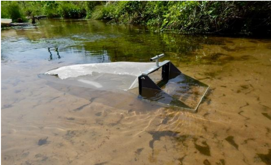
Figure 14 . Echantillonneur de type « surber » .
