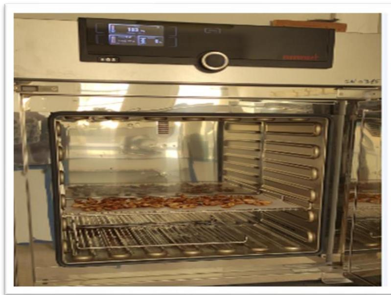
**Figure 21.** Les dattes dans l'étuve de séchage 70°C (photo prise par nous-mêmes en 2021).
