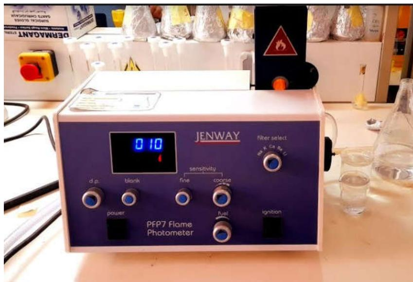
**Figure 05:** Photomètre a flamme
