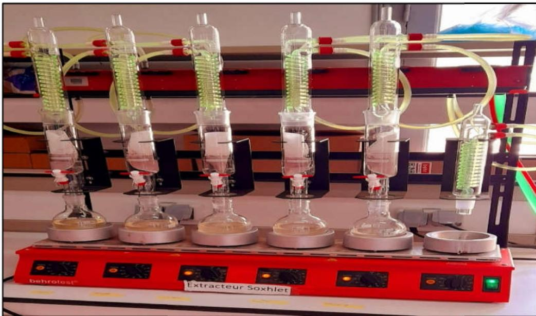
Figure 15: Opération d'extraction de l'huile par le Soxhlet
