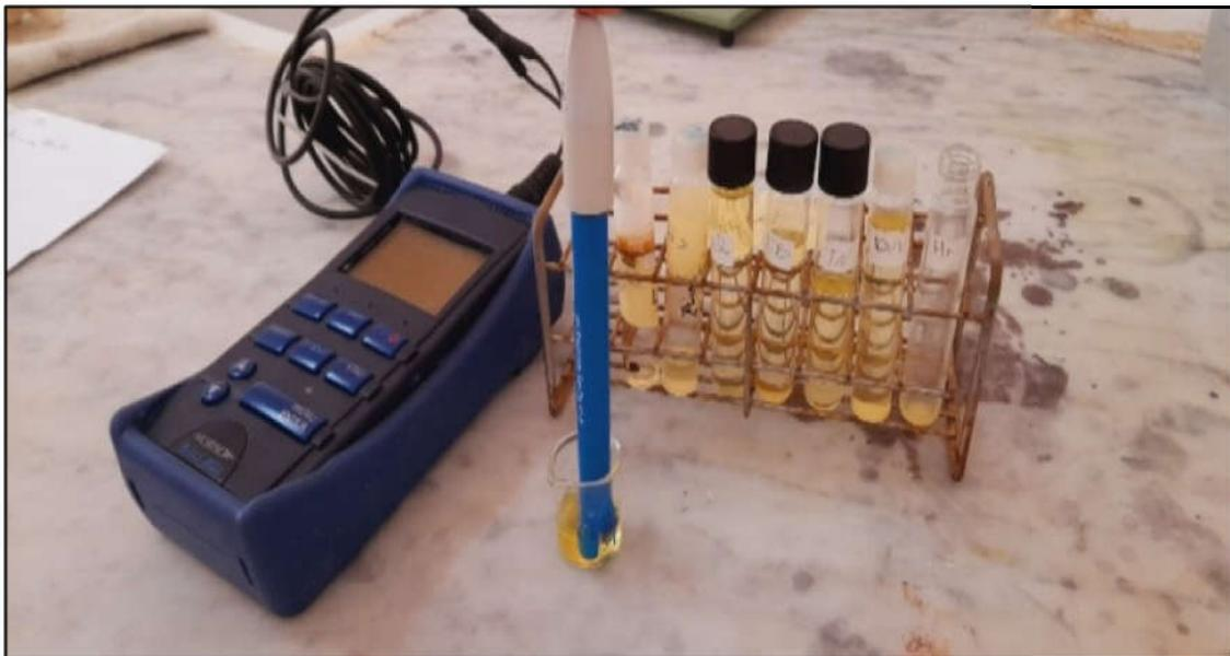
**Figure 9:** Mesurer du pH de l'huile des noyaux de dattes
