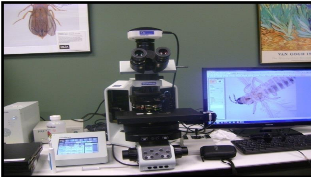
Figure 11. Microscope Olympus utilisé pour identifier et photographier les espèces de thrips collectées (Razi et al. , 2017) .
