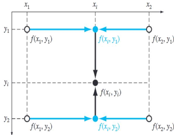
FIG. 3.3 – L'interpolation bilinéaire bidimensionnelle peut être mise en oeuvre en appliquant d'abord une interpolation linéaire unidimensionnelle dans la dimension  $x$  pour déterminer les valeurs en  $x_i$ . Ces valeurs peuvent ensuite être utilisées pour interpoler linéairement dans la dimension  $y$  afin d'obtenir le résultat final en  $x_i, y_i$ .
