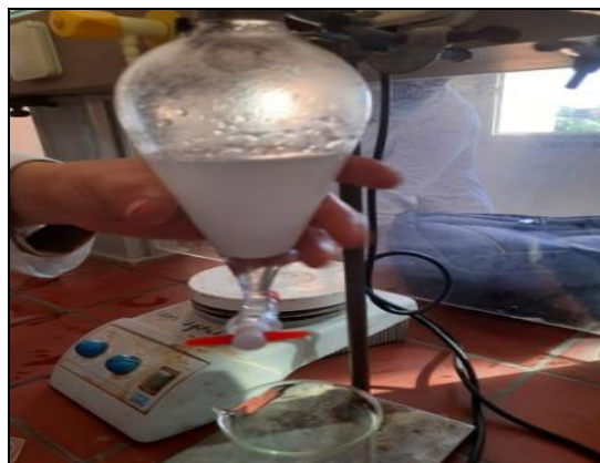
Figure III. 10 l'ampoule à décanter (séparation des phases ).
