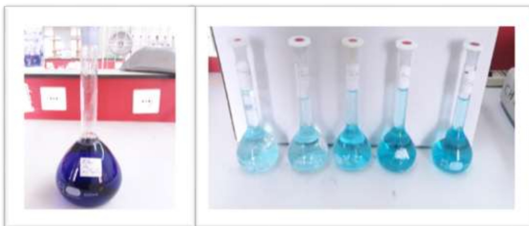
Figure II.16: Solution mère et solutions filles du bleu de méthylène.
