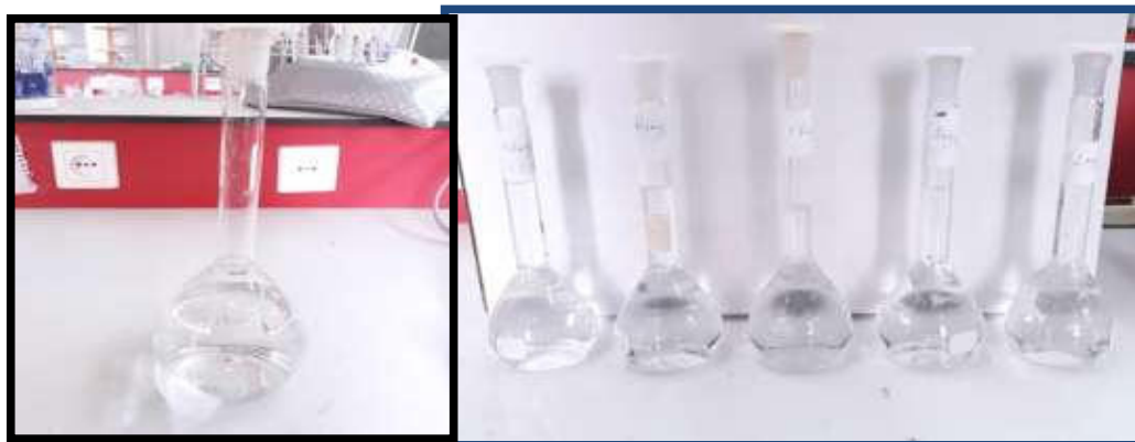
Figure II.19: Solutions mère et filles de phénol utilisées pour la courbe d'étalonnage.
