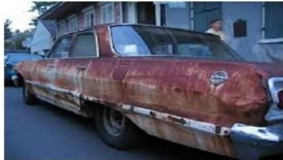
FIGURE II.1: Corrosion générale (rouille) d'une pièce en acier
