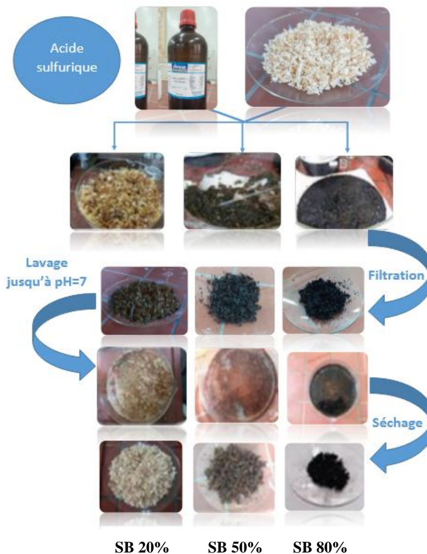
Figure 06. prétraitement à l'acide sulfurique.
