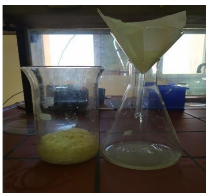
Etape 3(Filtration après 24h)
