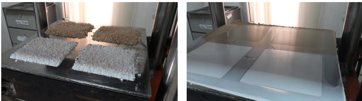
Figure .II. 6. Images des plaques avant et après passage à la presse.
