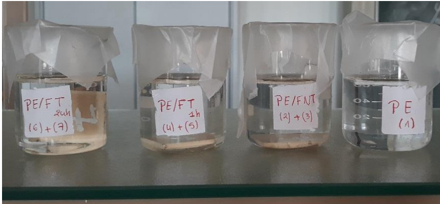
Figure .II. 11. Test d'absorption d'eau pour les composites PEBD/ Fibres de bois
