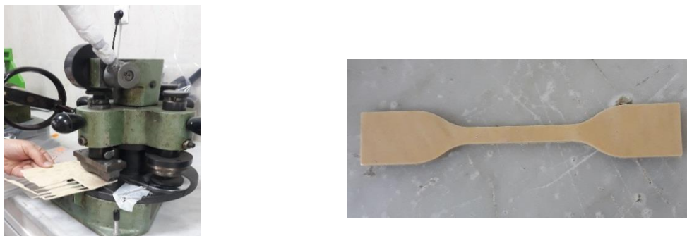
Figure .II. 7. Le découpage des plaques sous forme d'haltères par la découpeuse
