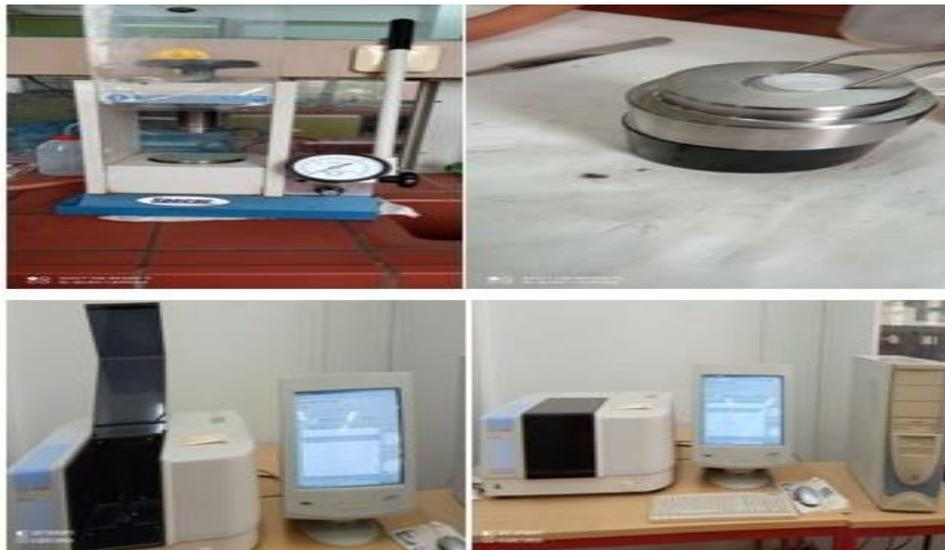
**Figure II.4 :** spectromètre Infrarouge à transformée de Fourier FTIR-Shimadgu 8400S
