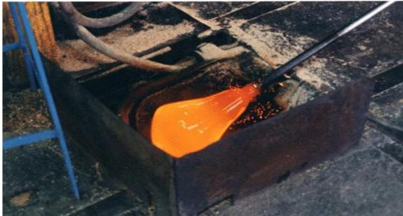
**Figure I-3 :** La paraison est prête au bout de la canne à souffler.
