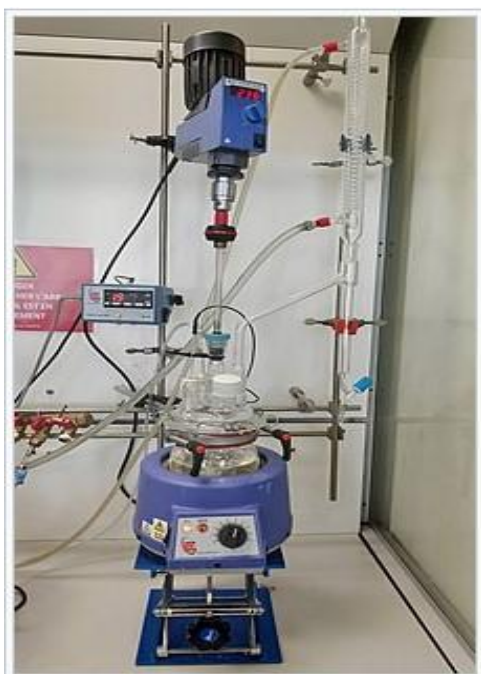
Figure II.2 : Montage de polycondensation pour la synthèse de polyester insaturé
