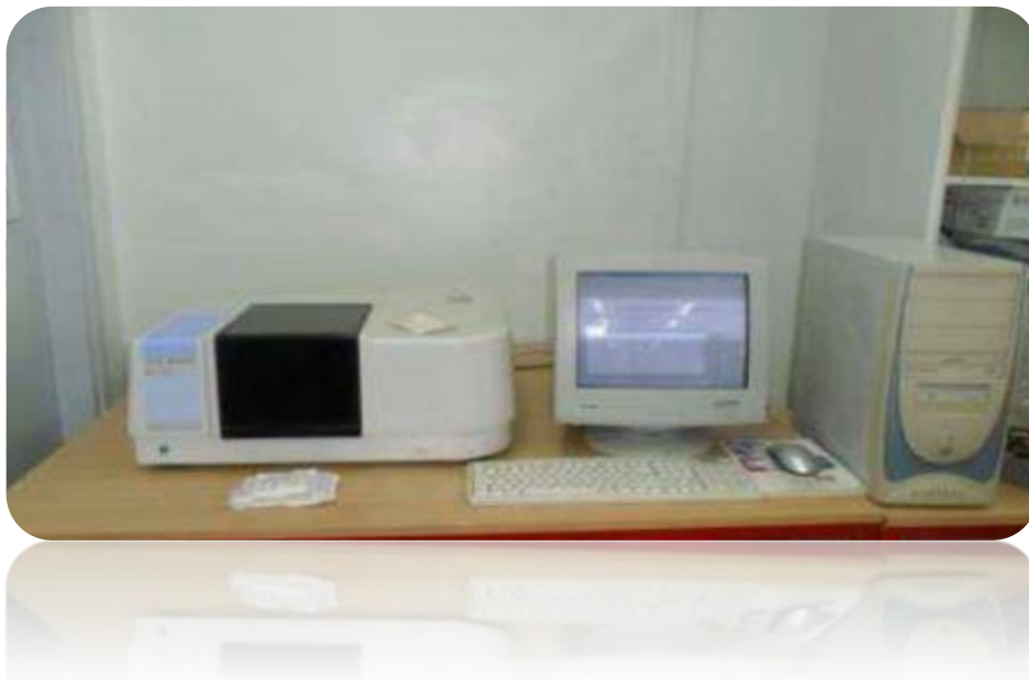
Figure II.9: Spectromètre Infrarouge à transformée de Fourier FTIR-Shimadzu8400S.
