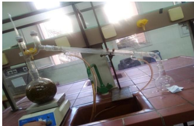
Figure3 : Montage d'hydrodistillation de thym
