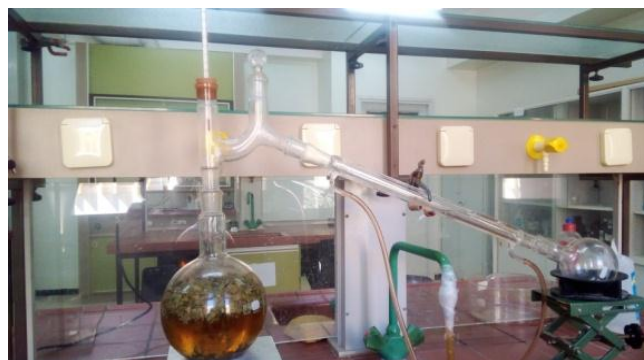
Figure 4 : Montage d'hydrodistillation d'eucalyptus
