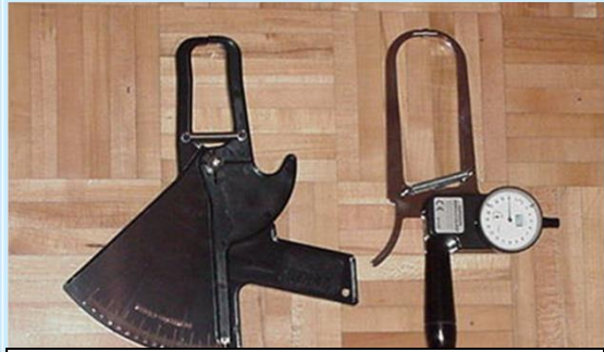
الشكل 1: تمثل جهاز قياس ثنايا الجلد (Skinfold Calipers) (1).
