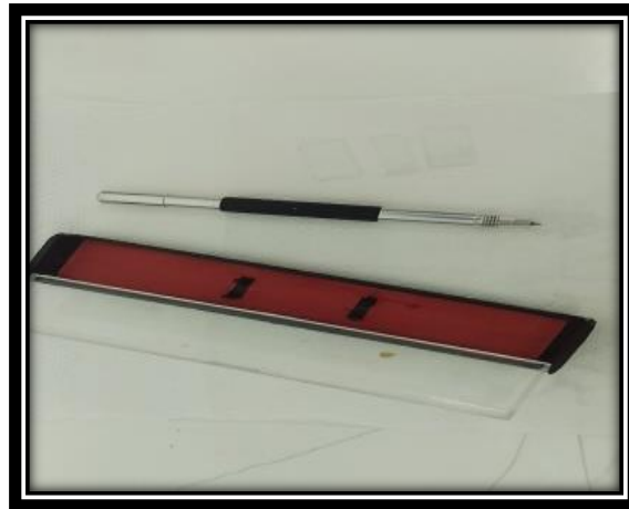
Figure III.1: Substrats en verre et stylo à pointe en diamant.
