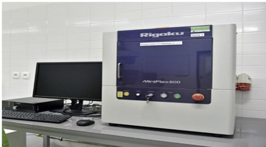
Figure II. 4 : Diffractomètre de type Rigaku_Miniflex600.
