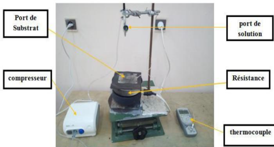
Figure III.1 : montage expérimental du système de spray pneumatique
