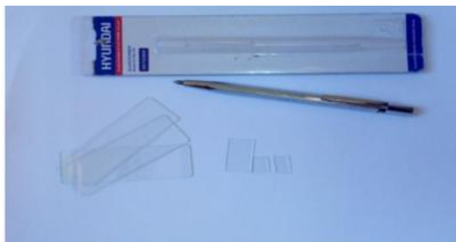
Figure III.2 : Substrats en verre et stylo à pointe en diamant.
