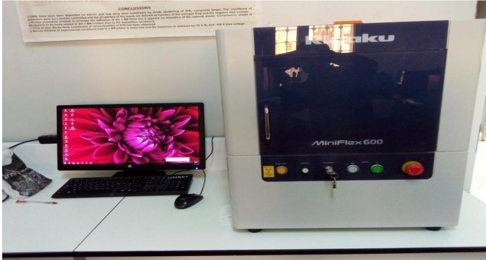
**Figure II.9 :** diffractomètre de type (Miniflex600).
