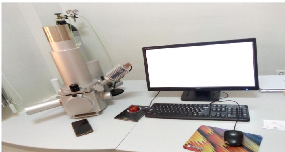
**Figure II.17 :** Le microscope électronique à balayage MEB de type (VEGA3).
