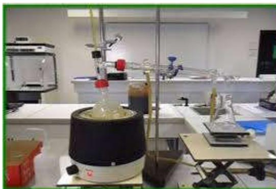
**Figure(II.5) :** extraction par hydro distillation
