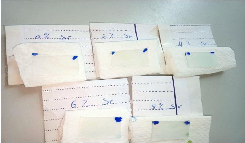
الشكل (III-5): الطبقات الرقيقة المتحصل عليها بطريقة الرش الكيميائي الحراري.
