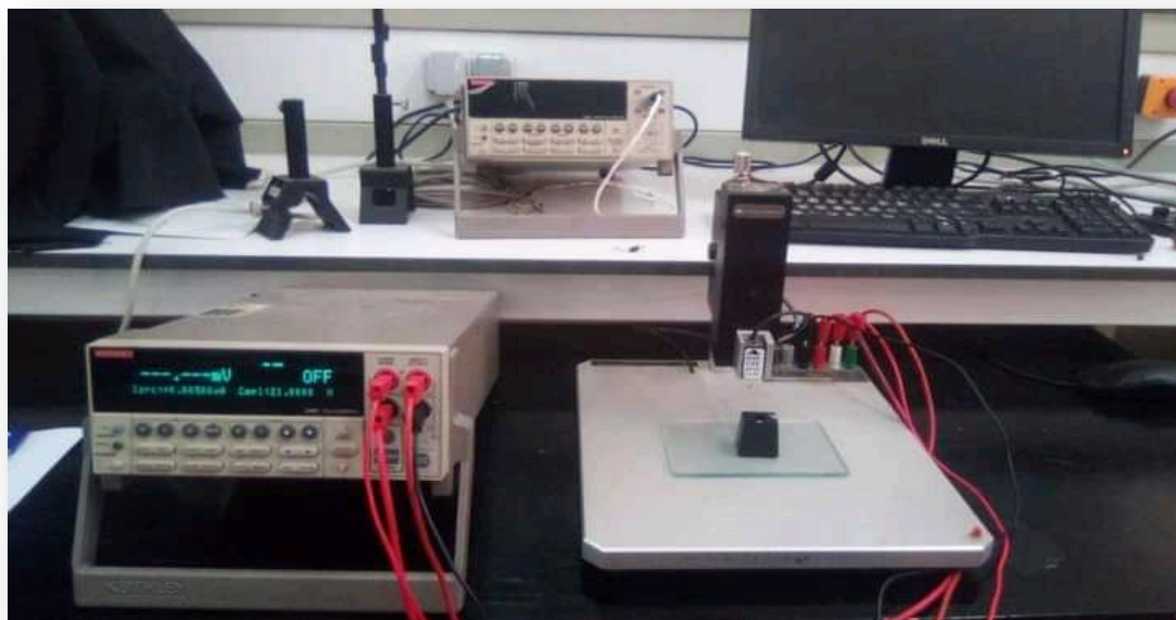
الشكل (16.III) : صورة لجهاز مطيافية النقطة الرابعة " جامعة محمد خيضر-بسكرة "
