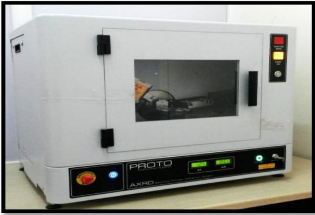
الشكل (16-II): جهاز انعراج الاشعة السينية (DRX) المستخدم [35]
