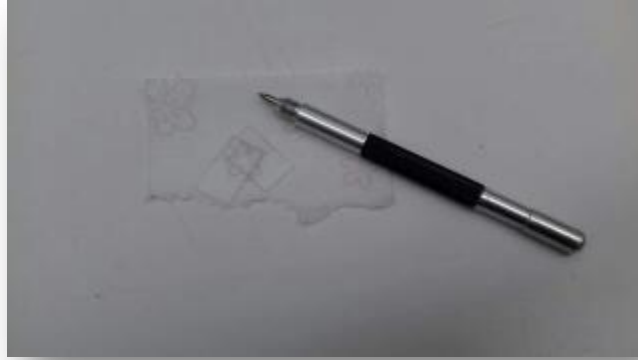
الشكل (3.III): صورة للركائز الزجاجية المستخدمة مقطوعة بقلم حاد
