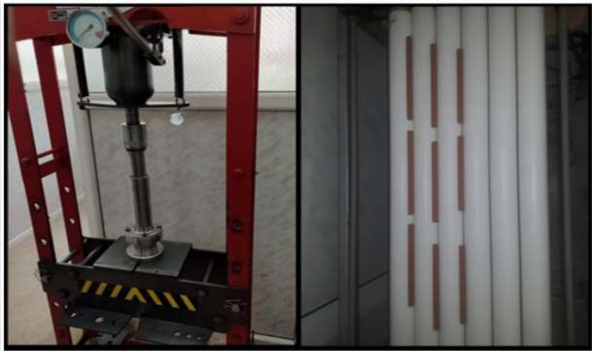
الشكل (12-II): صور لعملية الاستخراج ووضع العينات على أنابيب الألمنيوم الدوارة
