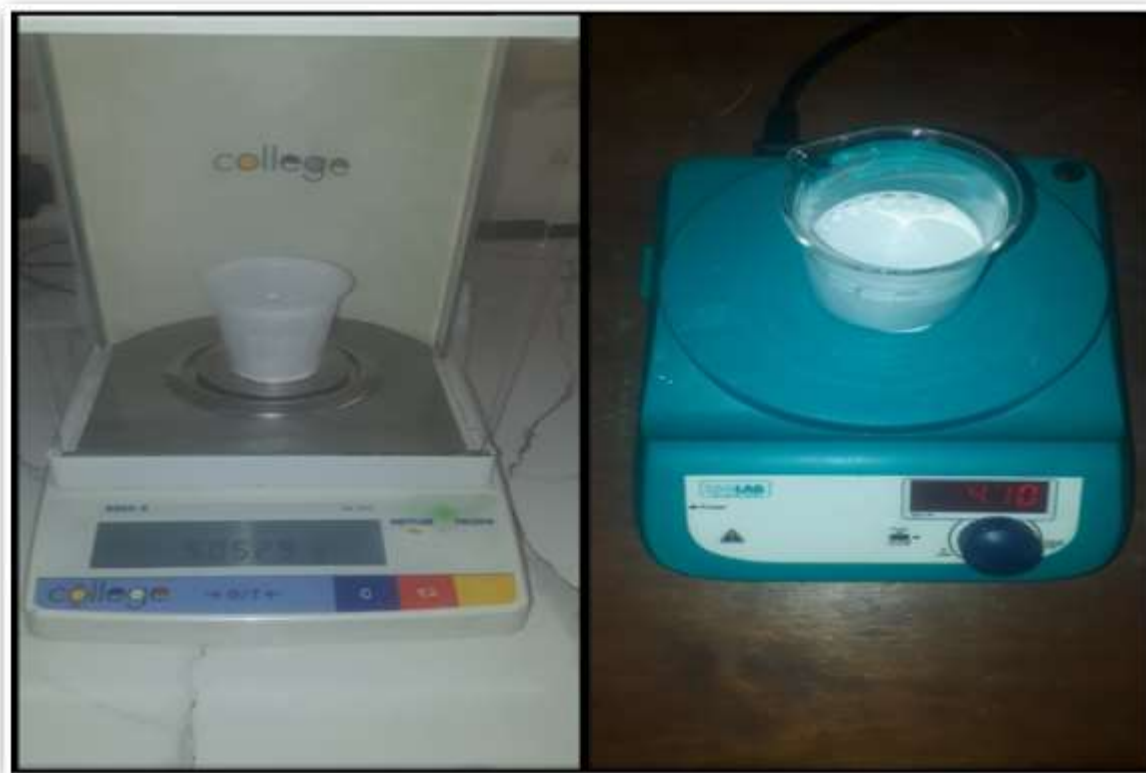
الشكل (II-16): صور لوزن المقادير وعملية الخلط بالخللاط المغناطيسي
