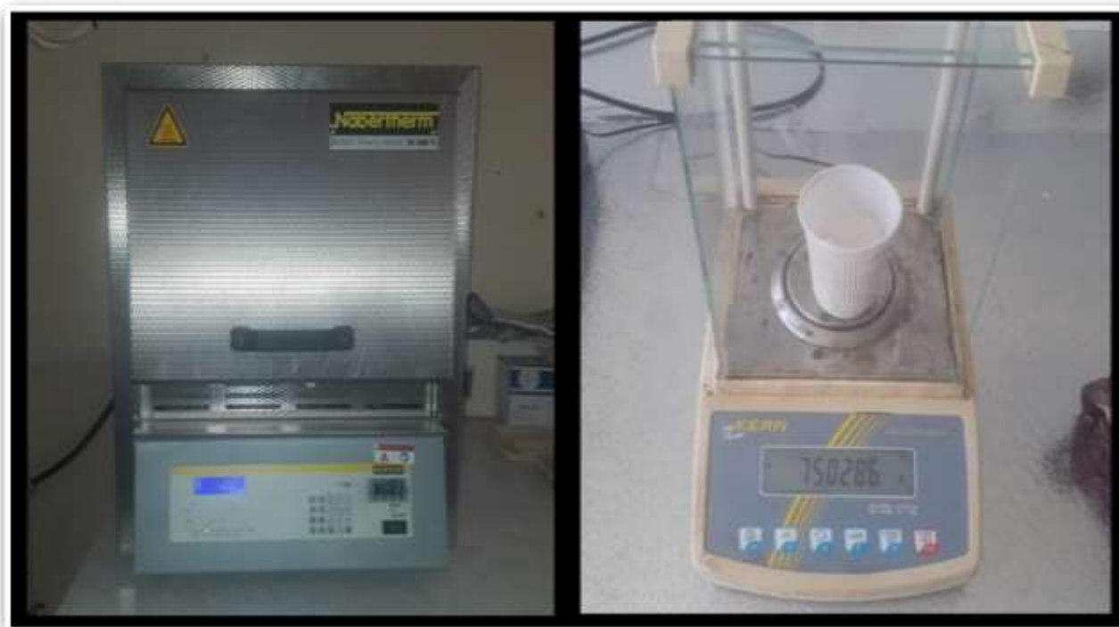
الشكل (10-II): صور لمعالجة الحرارية الكاولان (F2) عند 600^{\circ}\text{C} ووزن المواد الأولية
