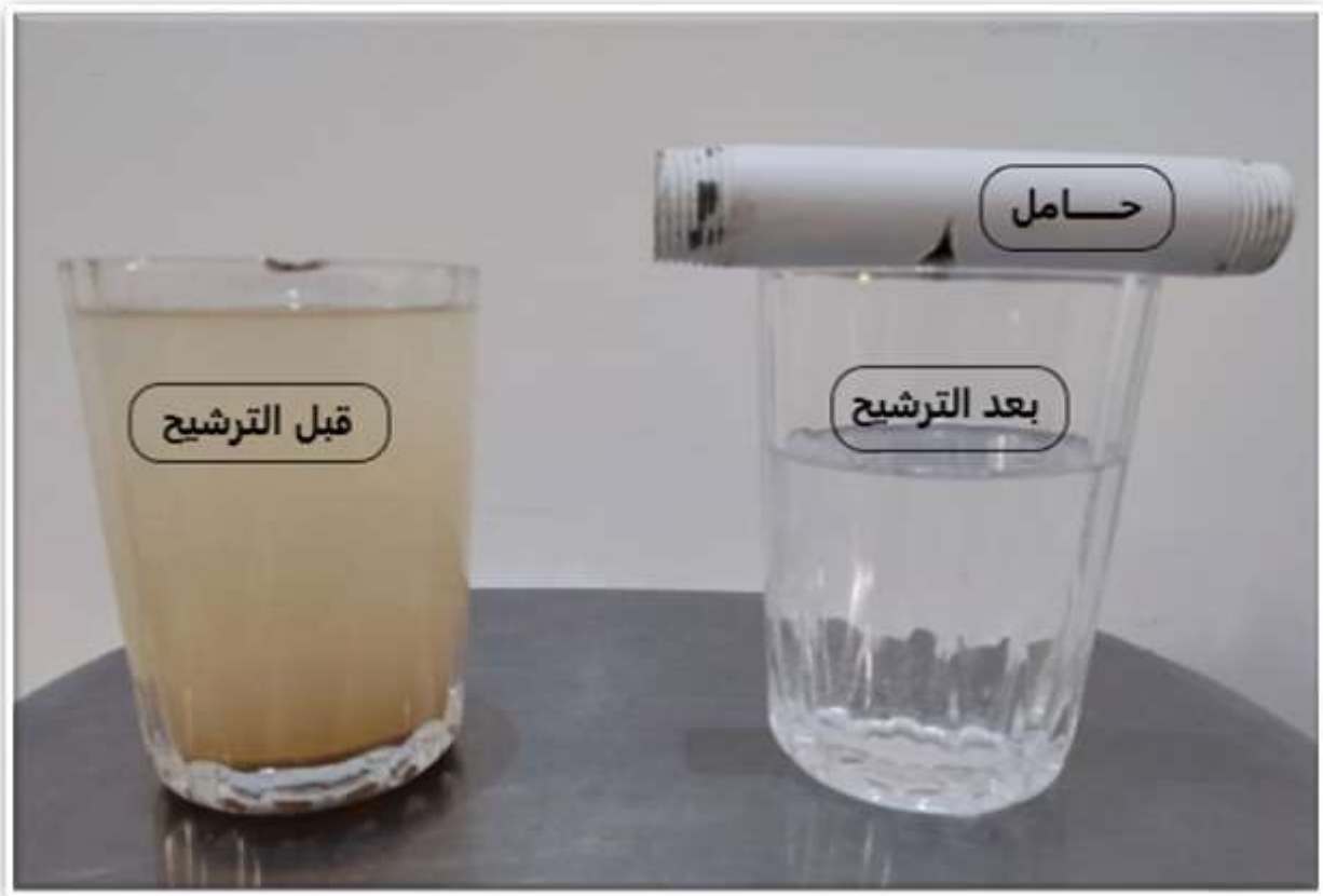
الشكل (III-18): صورة توضح فعالية المرشحات المحضرة في التخلص من العكارة واللون.
