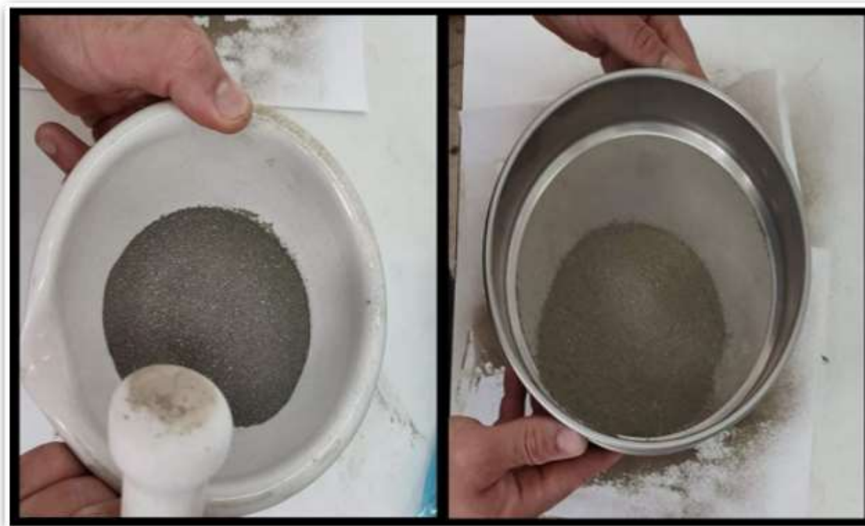
الشكل (9-II): صور لعملية السحق والغريبله المواد الأولية
