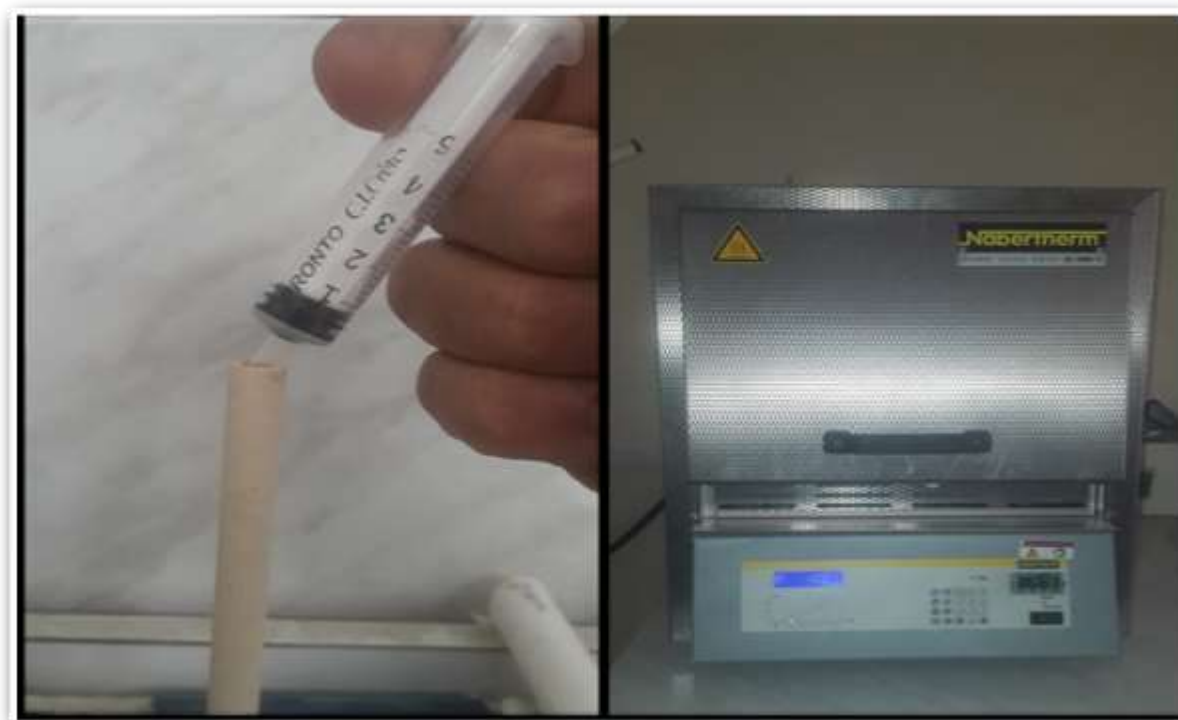
الشكل (II-17): صور لعملية الصب محلول ( TiO_2 ) داخل المسند والمعالجة الحرارية عند 1150^{\circ}C
