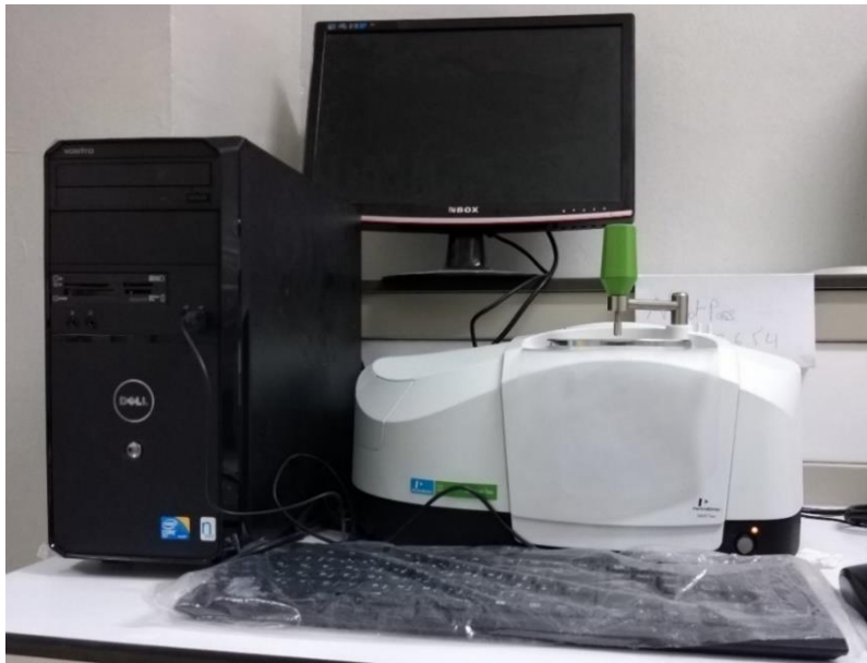
الشكل (II-17): جهاز مطياف الأشعة تحت الحمراء Perkin Elmer FT-IR spectrometer
