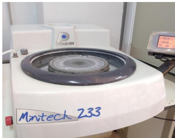
الشكل (6.11): الصورة توضح آلة الصقل المستخدمة في صقل العينات Megabel Pressi233
