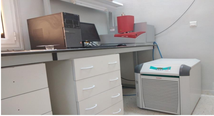
الشكل (II.10): جهاز المسعر التفاضلي الماسح DSC
