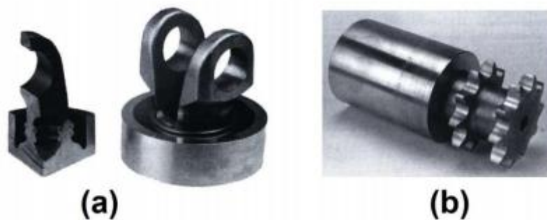
Figure I. 17. a) Piston d'un moteur diesel. b) Remplacement de pièces forgées ou coulées par des profilés standards [3].
