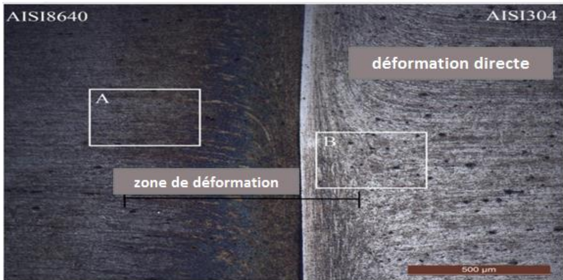
Figure. II. 13. Vue au microscope optique de la zone soudée [2].
