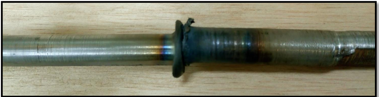
Figure III. 3. Soudage par friction rotation de deux échantillons dissimilaires (Acier X70 et Acier inoxydable Duplex).
