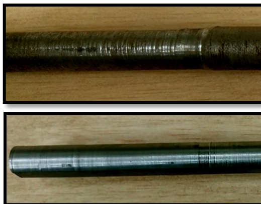
Figure III. 1 : Métaux de base (Acier X70 et Acier inoxydable Duplex).
