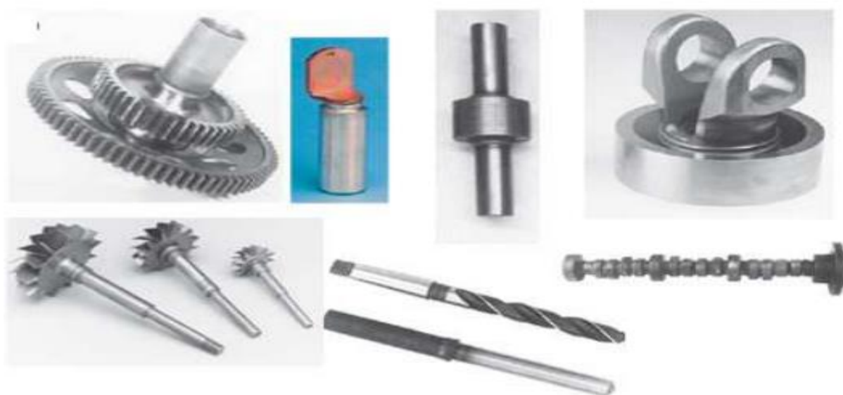
Figure. I.10. Exemples de pièces soudées par friction rotative[15].
