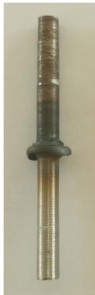
Figure IV. 2. Macrographie du joint soudé avec une vitesse de rotation de 2000 tr./min.
