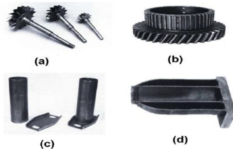
Figure I. 16. a) Pièce d'un turbo. b) Partie d'une boîte de vitesse. c) Partie d'un amortisseur tube soudé à une pièce compressée. d) Partie d'un cric hydraulique : le tube à double paroi est soudé en une fois [3].
