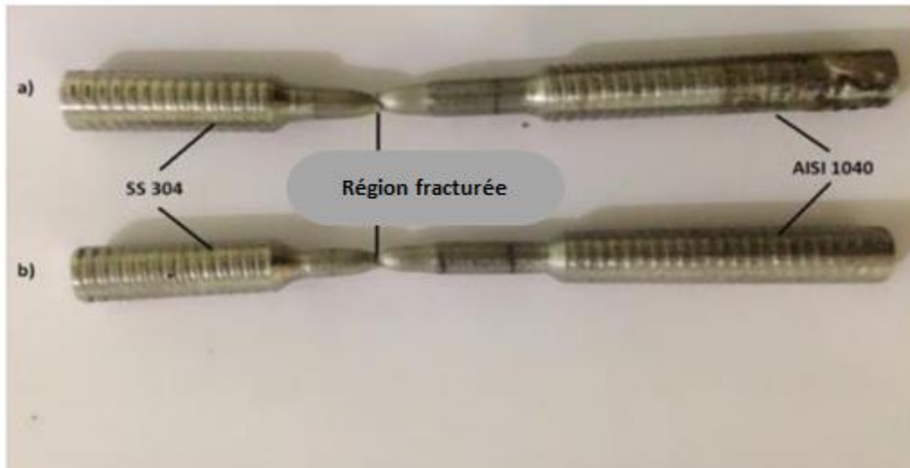
Figure. II. 18. Eprouvettes soudées après essais de traction[3].
