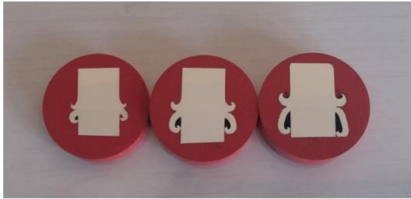
Figure. II. 9. Macrophotographie d'échantillons soudés et polis[2].
