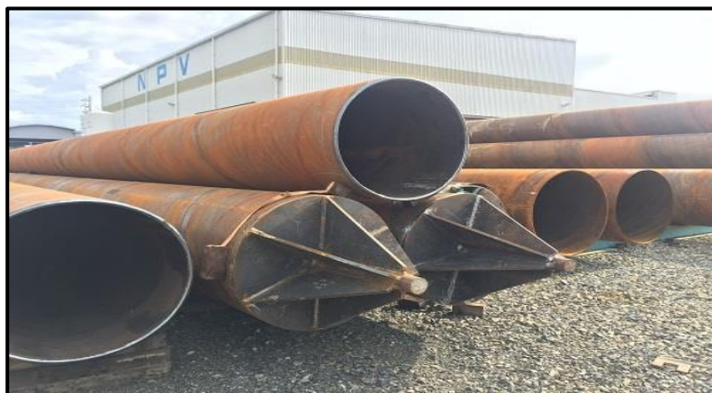
Figure I.5 : Des Pipelines Montrant une Corrosion Uniforme [10].
