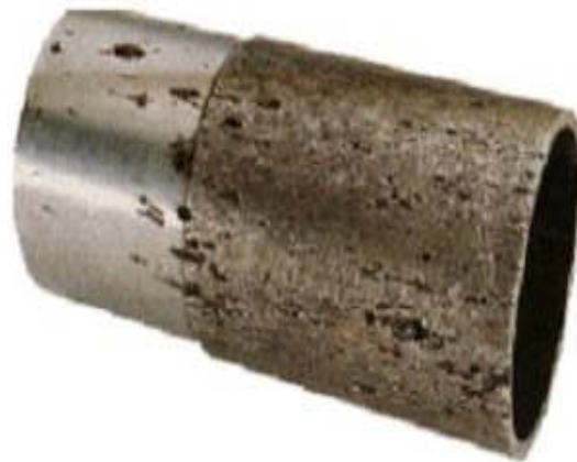
Figure 1-4 : Corrosion par piqûres d'un acier inoxydable
