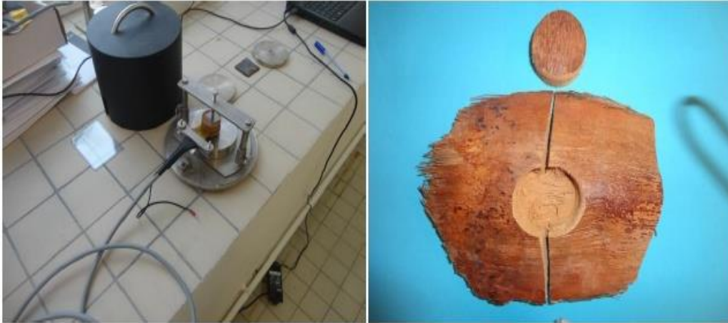
Fig. (11) : Mesure de la Conductivité thermique du bois de palmier dattier
