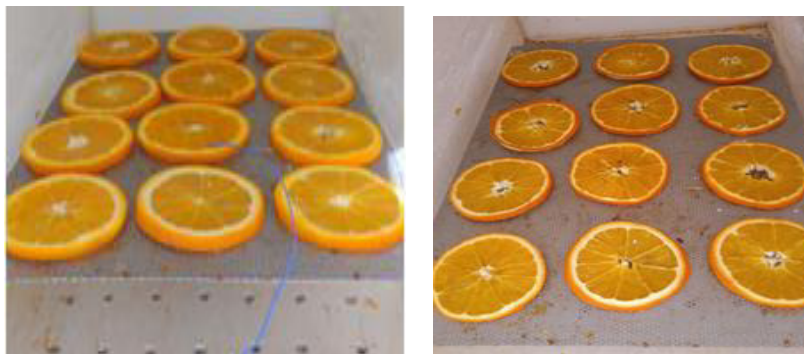
Figure (III-22): Tranches de orange humides et séchées avec chicanes de 7mm d'épaisseur, 80mm de diamètre, le débit 0,019 Kg /s
