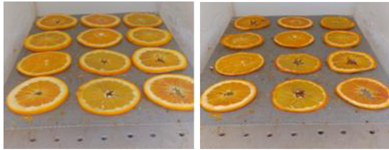
Figure (III-21): Tranches de orange humides et séchées avec chicanes de 5mm d'épaisseur, 80mm de diamètre, le débit 0,019 Kg /s
