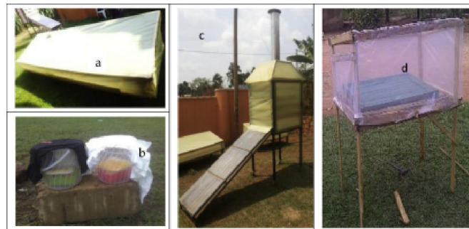
Figure (II-11) : Les quatre méthodes traditionnelles de séchage solaire et le sécheur solaire amélioré proposé. a) la méthode du séchoir solaire conventionnel (CSD), b) les méthodes du store en tissu blanc (WCS) et du store en tissu noir (BCS), c) la méthode du séchoir solaire amélioré (ISD), et d) le séchage traditionnel à ciel ouvert (OSD) méthode.
