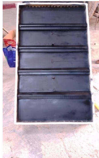
Figure (III-8): capteur solaire a chambre de séchage avec chicane
