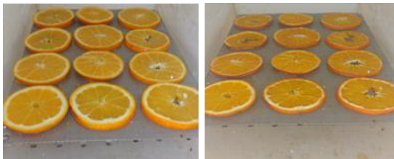
Figure (III-19): Tranches de orange humides et séchées sans chicanes de 7 mm d'épaisseur, 80mm de diamètre, le débit 0,024 Kg /s
