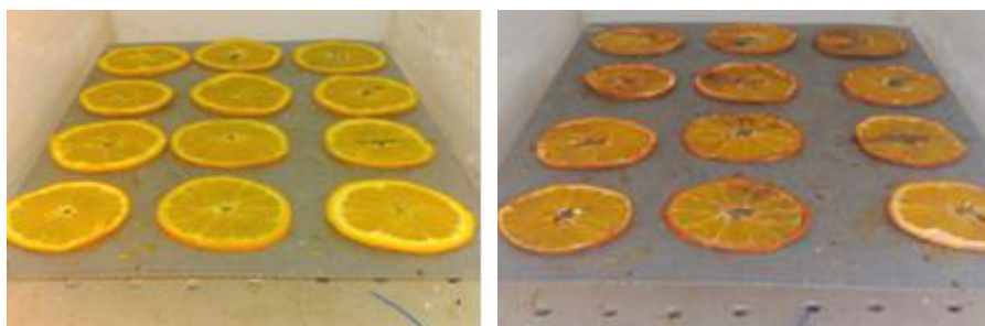
Figure (III-20): Tranches de orange humides et séchées avec chicanes de 3 mm d'épaisseur, 80mm de diamètre, le débit 0,019 Kg /s
