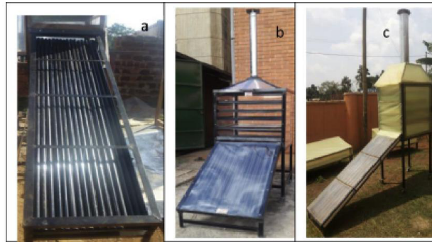
Figure (II-12): Le nouveau séchoir solaire amélioré (ISD) proposé pour les fruits tropicaux
