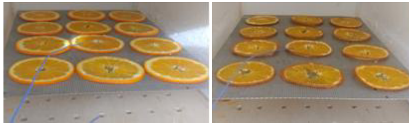
Figure (III-18): Tranches de orange humides et séchées sans chicanes de 5 mm d'épaisseur, 80mm de diamètre, le débit 0,019 Kg /s
