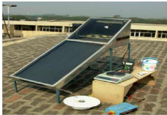
Figure (II-30) : Installation expérimentale pour le séchage solaire en mode mixte par convection naturelle.
