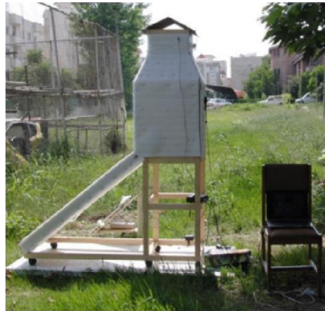
Figure (II-8): Photo du séchoir solaire testé.
