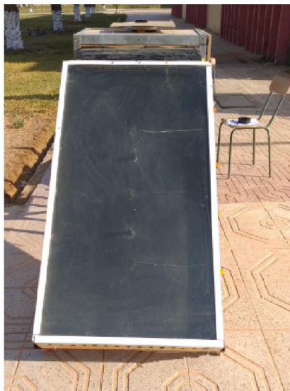
Figure (III-7): capteur solaire avec chambre de séchage sans chicane
