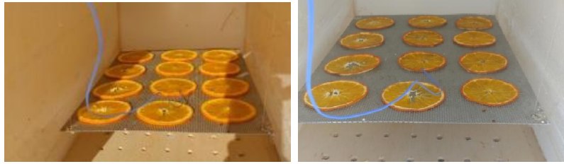
Figure (III-17): Tranches de orange humides et séchées sans chicanes de 3 mm d'épaisseur, 80mm de diamètre, le débit 0,019 Kg /s
