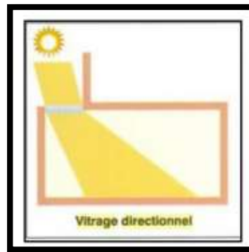
Figure 103 :vitrage directionnel (Sigrid R, André D.H ,2005)
