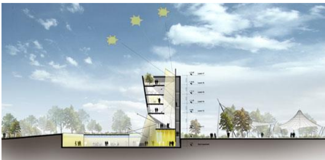
Figure 61: Système d'éclairage naturel dans le CSET
