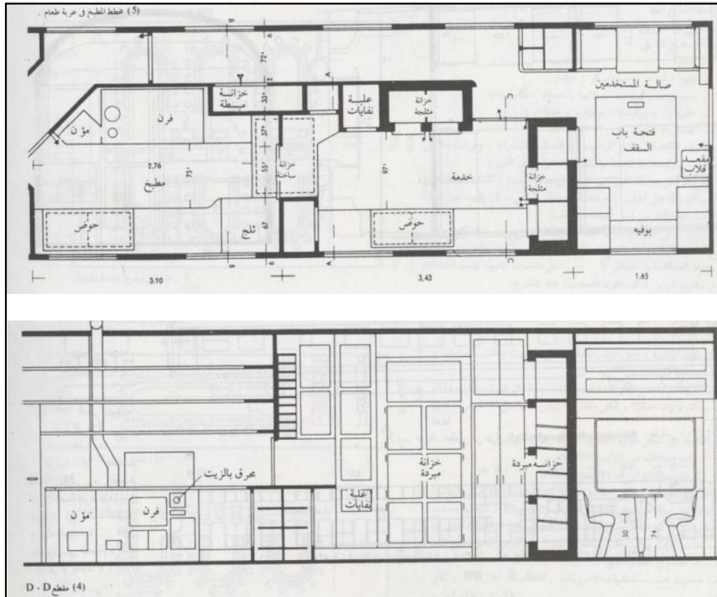
الشكل رقم 16- رسم توضيحي لمقطع ومخطط لمطبخ.
