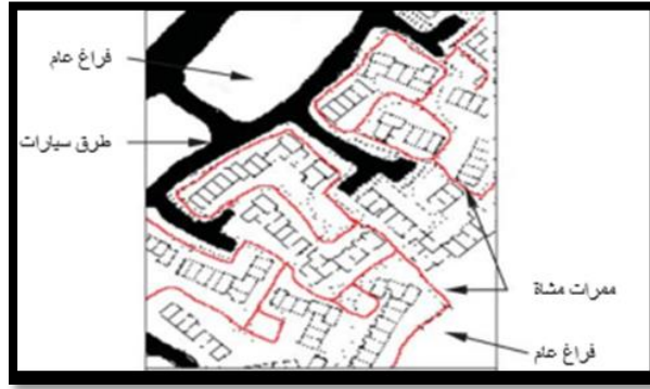
الشكل رقم I-5: رسم توضيحي يبين الفصل بين الحركة الآلية وحركة المشاة. المصدر: (BENTELY, 1985), (بتصرف الباحثة).
