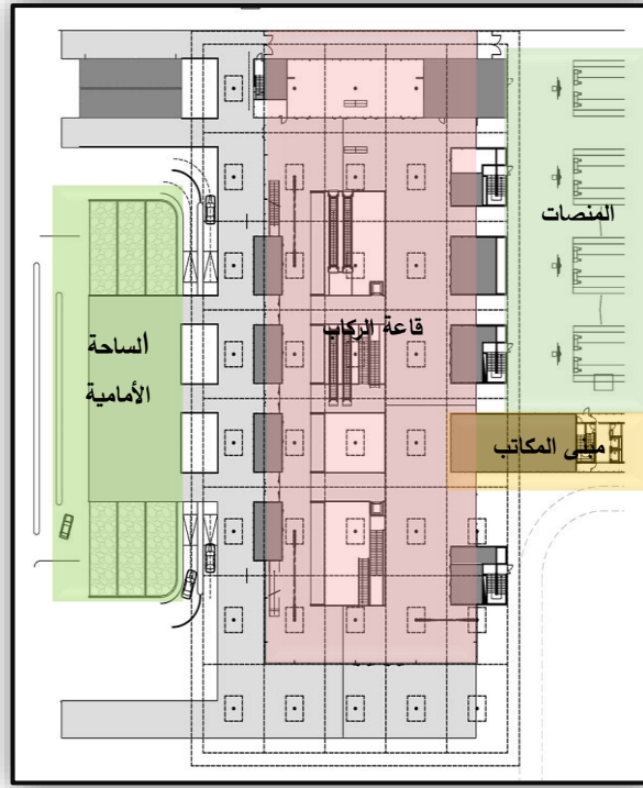
الشكل 29: مخطط يوضح توزيع القطاعات الكبرى المكونة لمحطة قطار الدار البيضاء
