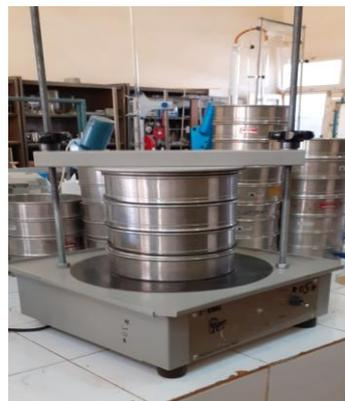
**Figure(III.5) :** Tamiseuse à vibration type D407.
