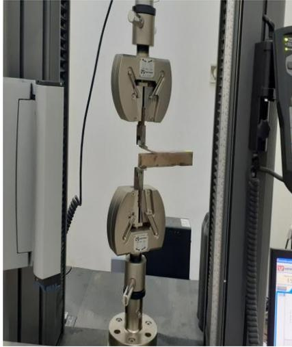
**Figure (III.18) :** Essai de délamination
