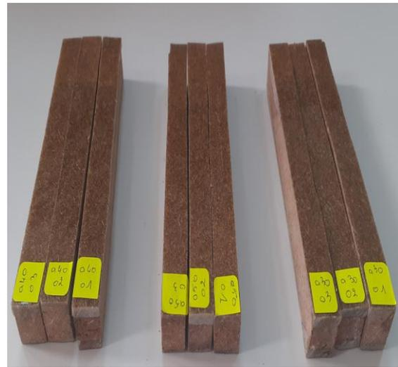
**Figure (III.26)** : Epreuve de sandwich avant l'essai
