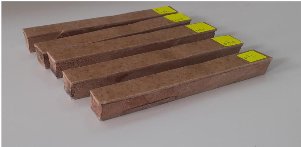
**Figure(III.14)** : Eprouvettes différenciées par pré défaut
