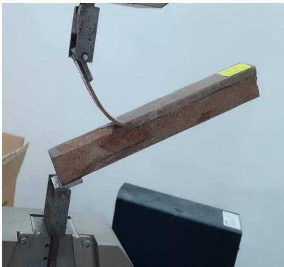
**Figure (III.27)** : Epreuve de sandwich après l'essai
