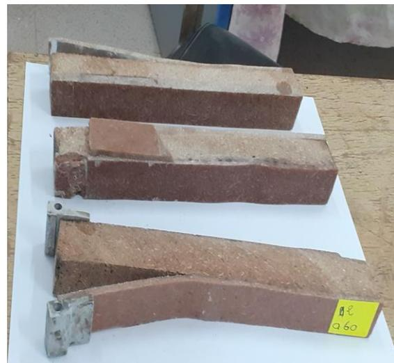
**Figure (III.28)** : Epreuve de sandwich après l'essai
