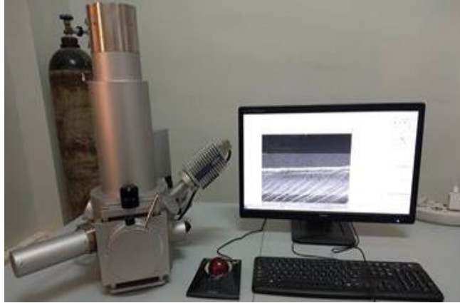
Figure .II. 5. Un microscope électronique à balayage de type TESCAN VEGA3
