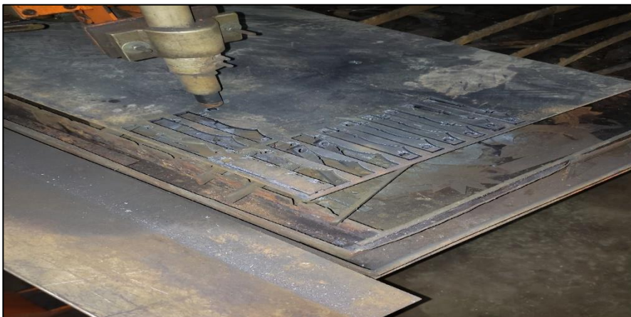
Figure 46 Découpe en CNC PLASMA de la tôle 6 mm d'épaisseur
