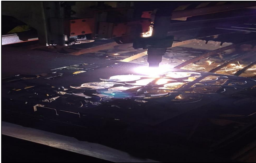
Figure 48 Découpe en CNC PLASMA de la tôle 5 mm d'épaisseur
