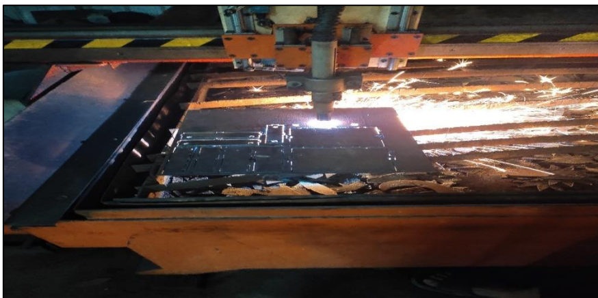
Figure 47 Découpe en CNC PLASMA de la tôle 3 mm d'épaisseur
