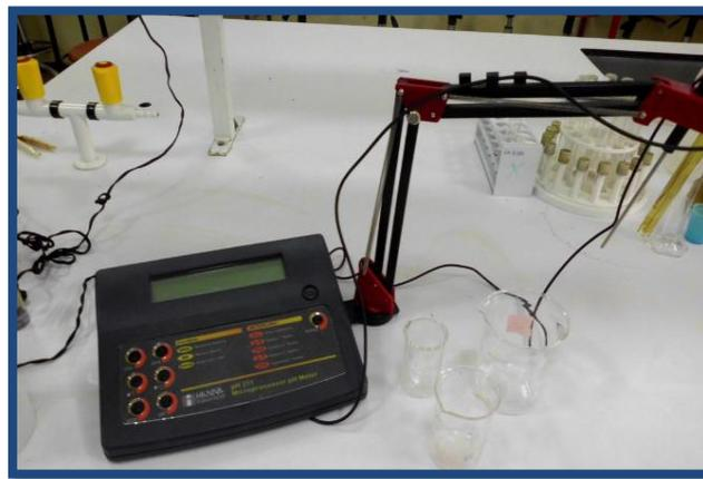
Figure .2.5. pH- mètre (pH 211micro processor pH micro HANNA)
