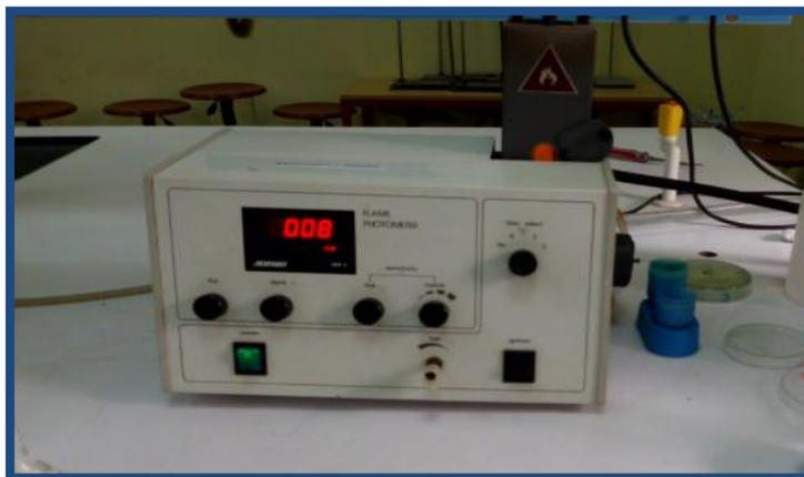
**Figure 2.10.** Photomètre à flamme (JEWWAY RFP7)
