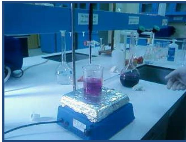
**Figure 2. 8.** La titration de calcaire actif
