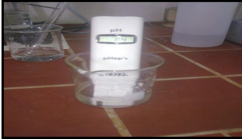
Figure II.14: Le PH mètre
