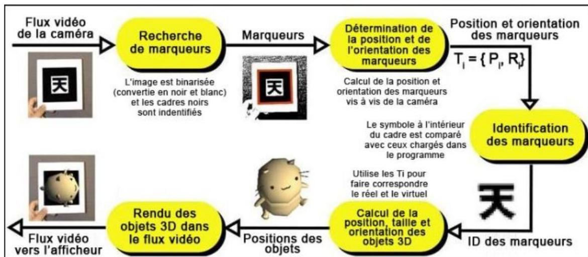
Figure2.7. Algorithme de détection d'ARToolkit
