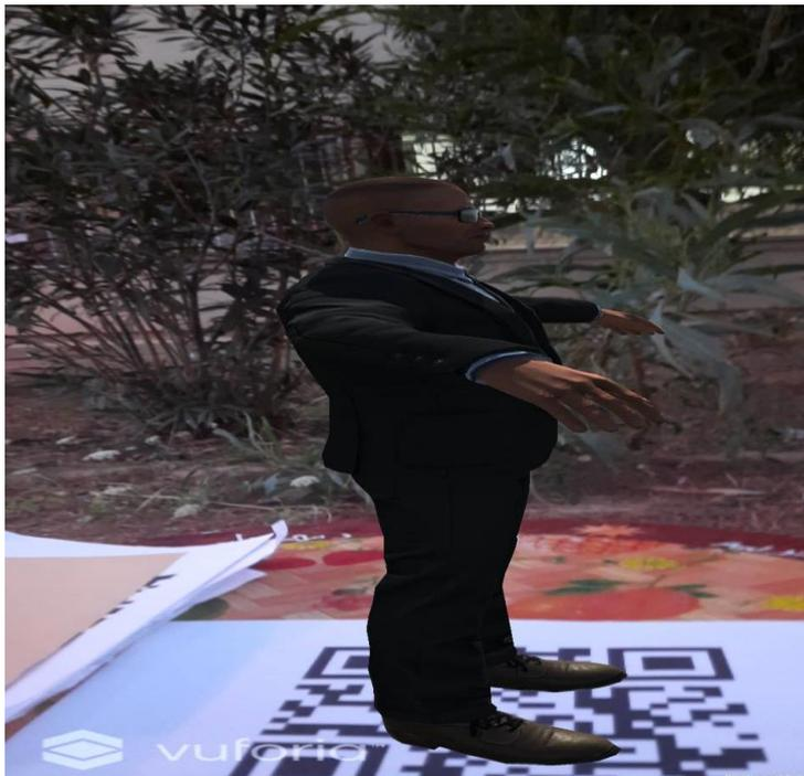
**Figure3.6.**L'objet suit l'orientation et la position des carrés noirs détectés
