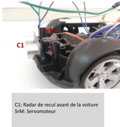
FIGURE IV.12 – Positionnement de servor motor.
