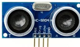
FIGURE IV.8 – Capteur ultrasonique
