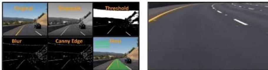
FIGURE III.5 – Différentes phases de la trame en cours de traitement.
