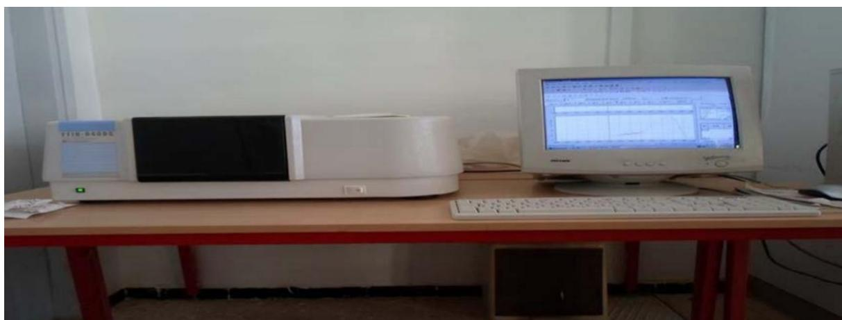
**Figure II.6.** spectromètre Infrarouge à transformée de Fourier FTIR-Shimadzu 8400S
