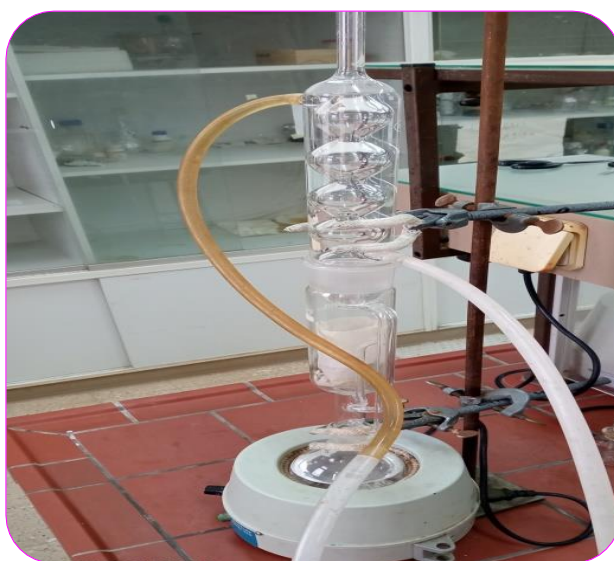
Fig.45: Extraction successive par le système Soxhlet.
