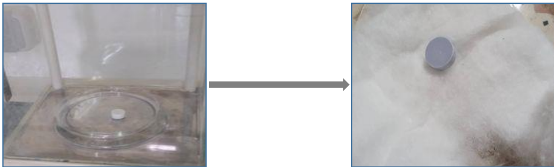
Figure III.1 : Changement de dimensions des pastilles sous l'effet de frittage pour HAP synthétique fritté à 1200 °C.
