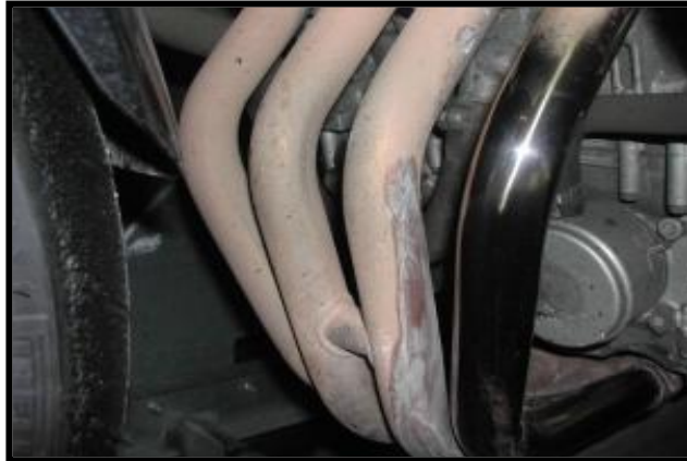
Figure I.3 : Exemple de la corrosion d'un collecteur d'échappement.
