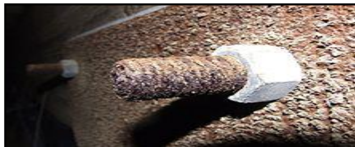
FigureI-1: Exemple de corrosion d'un métal
