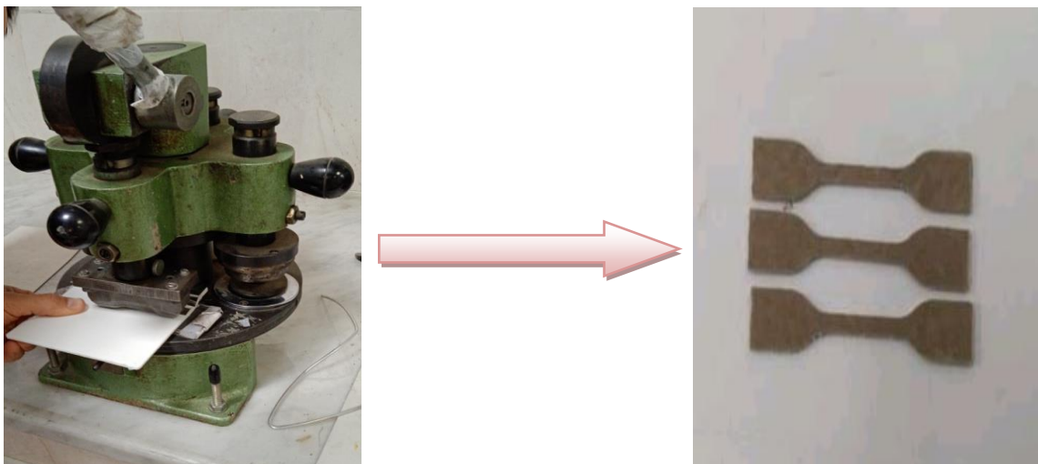
Figure .II. 9. Le découpage des plaques sous forme d'haltères par la découpeuse.
