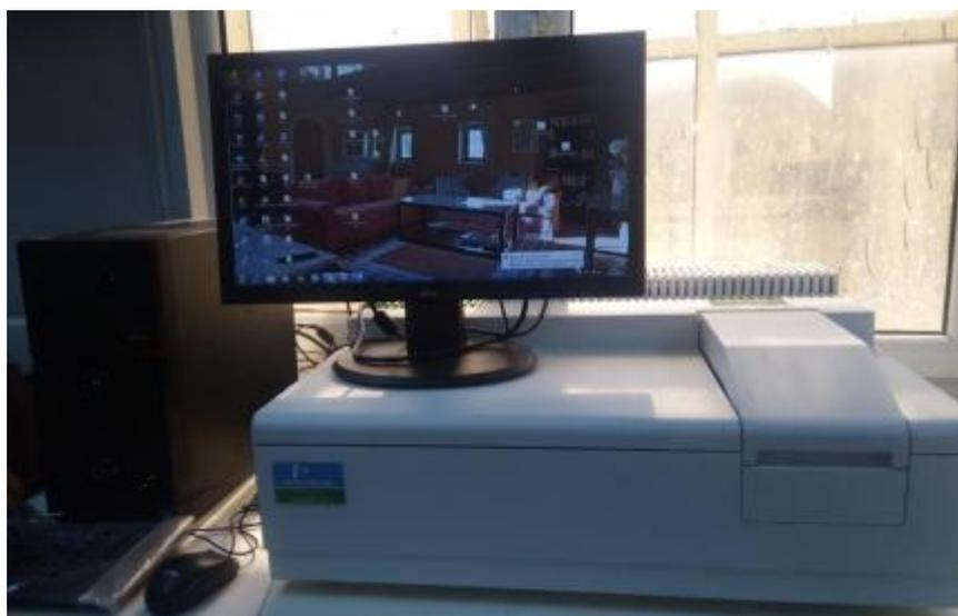
**Figure II.5.** Spectrophotomètre Uv -Visible
