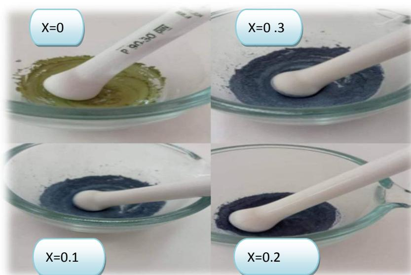
**Figure III.7 :** Poudres obtenues après la calcination pendant 6h à (1000°C pour  $\text{LaCrO}_3$ ) et (1100°C pour  $\text{LaCr}_{1-x}\text{Zn}_x\text{O}_3$   $x=0,1-0,3$ ).
